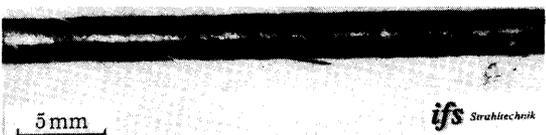
Abbildung 7. Nahtoberfläche einer WIG-Schweißung mit Laserunterstützung an austenitischem Stahl (X5CrNi 18 10, Blechdicke 2 mm, Stromstärke 100 A,  $P_{\text{Laser}} = 190 \text{ W}$ , Schweißgeschwindigkeit 650 mm/min).
